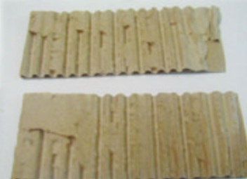
Prueba de pegue (100% rasgado)
