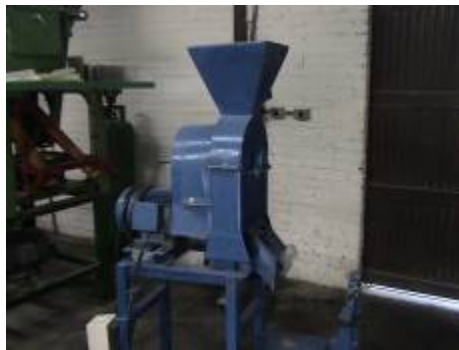
Foto 10: Molino de martillos móviles
