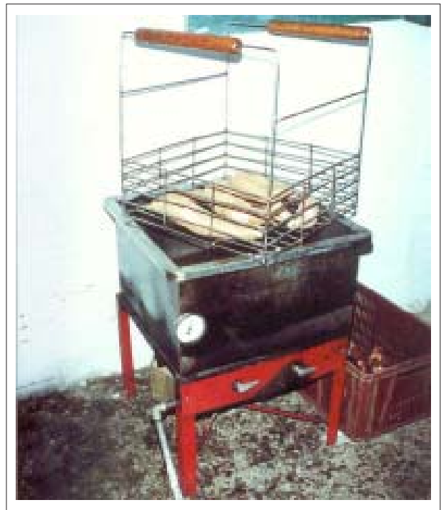
Figura 27-20. Canastilla de varilla de acero empleada para parafinar de 2 a 3 kg de raíces frescas de yuca.
