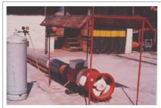
Figura 24-4. Sistema de calentamiento con ACPM, acoplado a un secador de capa fija.
