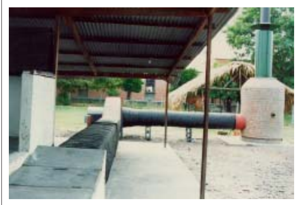
Figura 24-3. Secador artificial de capa fija con quemador de carbón para calentar el aire.
