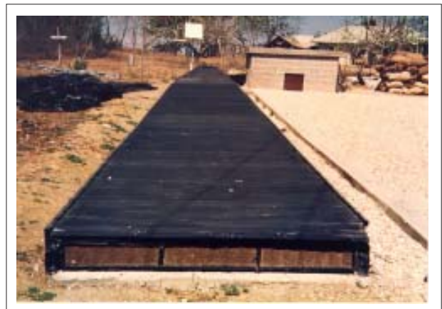
Figura 24-2. Secador de trozos de yuca que emplea un colector solar para calentar el aire.
