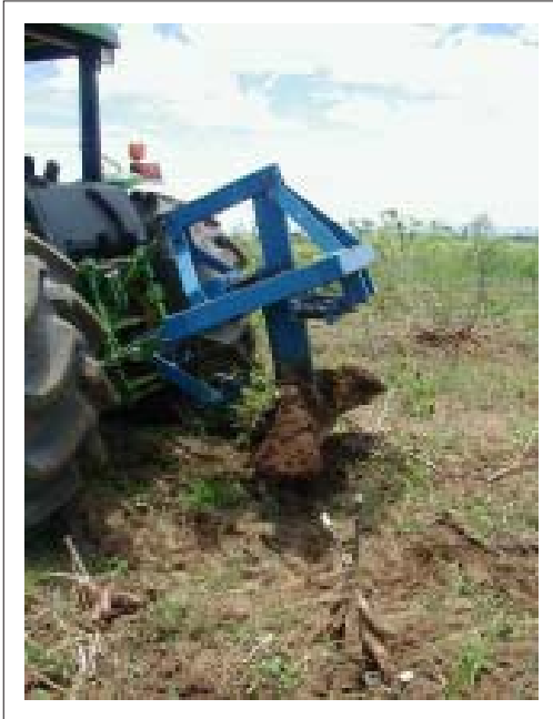
Figura 19-15. Implemento flexible para cosechar yuca, cuando entra en el suelo.
